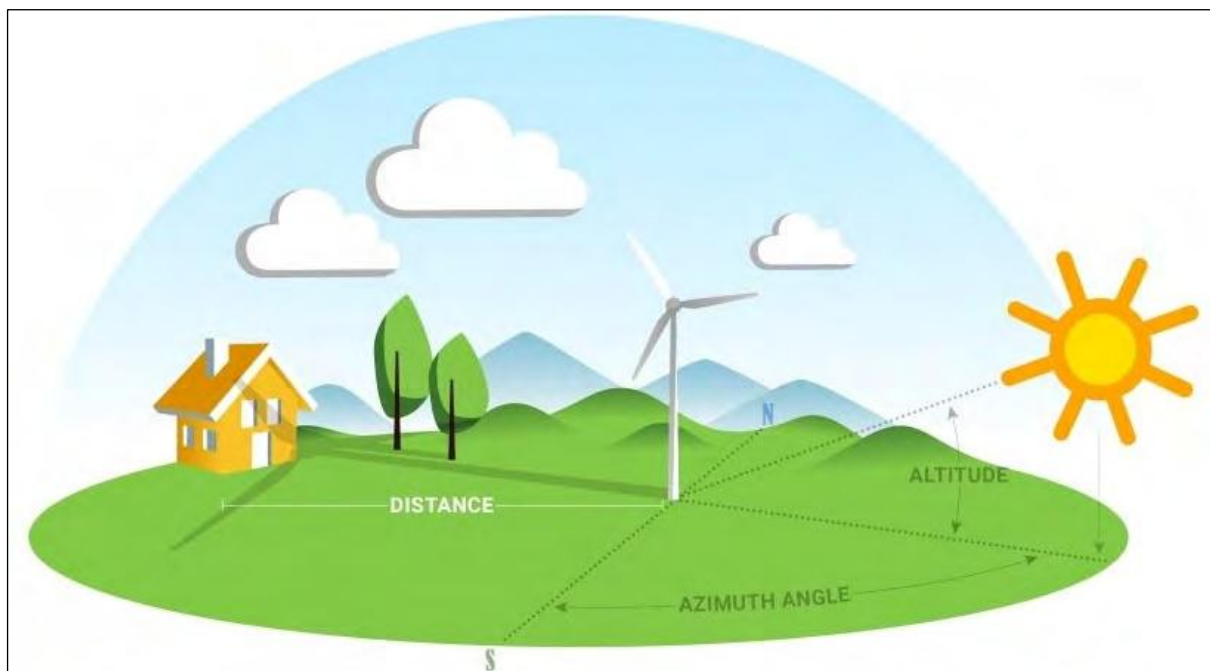
Obrázok 18: Ilustrácia vzniku efektu blikajúceho tieňa
